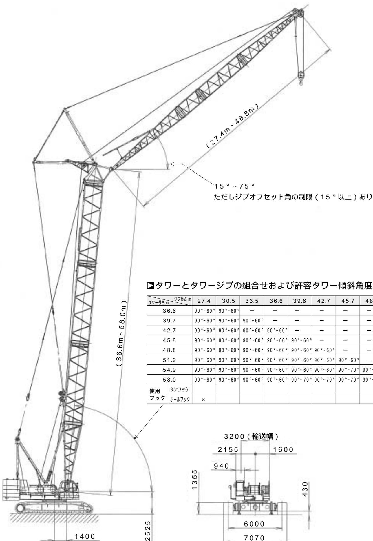
▶タワーとタワージブの組合せおよび許容タワー傾斜角度
