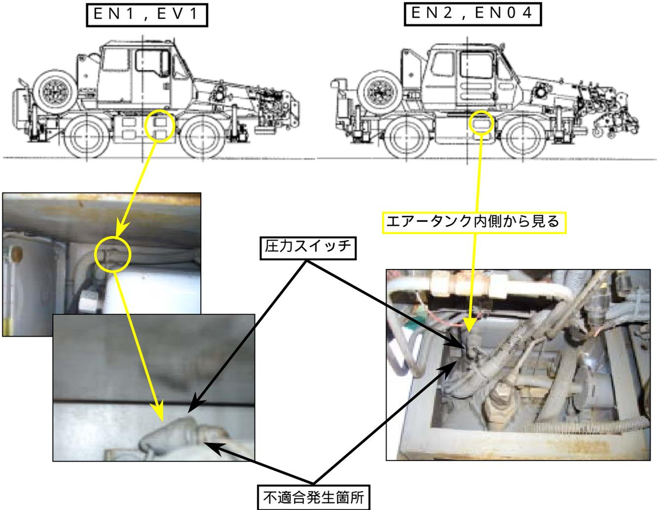
空気・油圧複合式主制動装置において、真空圧力低下を知らせる圧力警報装置の圧力スイッチの補修部品に誤った部品が出荷されたため、整備時等に圧力設定値の異なる圧力スイッチが取り付けられたものがある。
