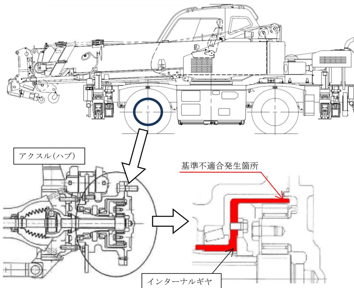
ホイール・クレーンのアクスル(ハブ)において、インターナルギヤの強度が不足しているため、ギヤに亀裂が生じることがある。そのため、そのままの状態で使用を続けると、ギヤが損傷し、走行ができなくなるおそれがある。
